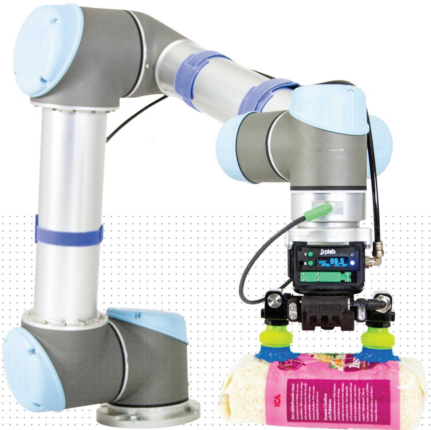
Der auf einem UR-Roboter montierte und mit diesem zusammenarbeitende piCOBOT® von Piab ist als flexibler „Mitarbeiter“ für eine Vielzahl von Fertigungs-, Verpackungs- oder Montagelinien konzipiert. Anpassungsfähig, leistungsstark, kompakt und leicht, ist er das ideale „Extra-Paar Hände“.
