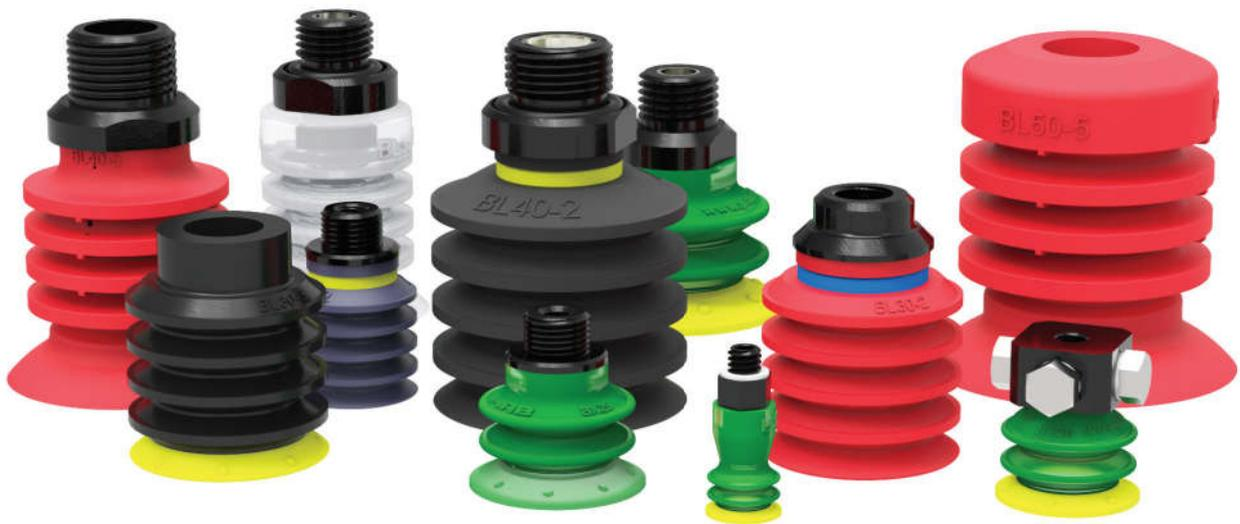
Diese Baureihe ist für Niveauunterschiede, leicht gewölbte Flächen und unebene Oberflächen ausgelegt. Anwendungsbereiche sind die Handhabung von Beuteln, Karton, Hochtemperatur-Anwendungen oder wenn der spezielle Bedarf der Berührung von Lebensmitteln besteht, da sie auch in einem Material erhältlich sind, das FDA-konform (FDA 21 CFR 177.2600) ist und die EU-Verordnung EU 1935/2004 erfüllt.
