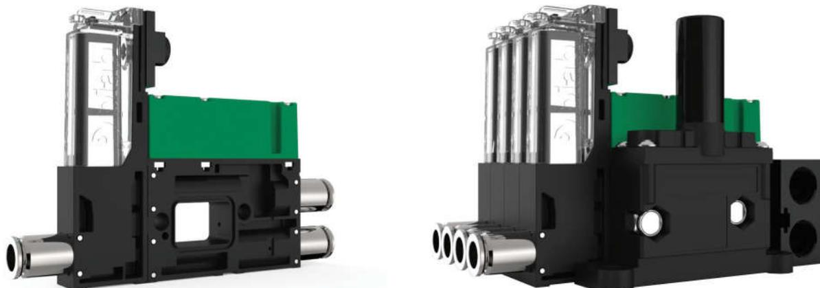
Kompakte/stapelbare Vakuumpumpen sind luftbetriebene, mehrstufige Ejektor-Baureihen, die auf der COAX®-Technologie basieren. Sie bieten eine hohe Betriebssicherheit bei schwankendem oder geringem Arbeitsluftdruck. Ausgezeichnete Leistung bei schneller Reaktionszeit, wenn ein tiefes Vakuumniveau erforderlich ist. Optional gibt es auch ein schnelles Vakuum-Rückschlagventil.
