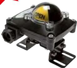
**Werkstoffe:** Gehäuse: Aluminiumdruckguss, Deckel: Polycarbonat, Schaltwelle: Edelstahl, Dichtungen: NBR, Montagebrücke: Stahl lackiert, Schrauben: Edelstahl/Stahl verzinkt
