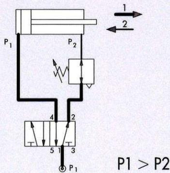
Wird nur der volle Zylinderschub in eine Richtung benötigt (z.B. beim Ausfahren) und für die andere Richtung ist nur ein geringerer Druck erforderlich, so kann eine Menge Energie durch Vorschalten eines Reglers eingespart werden.
