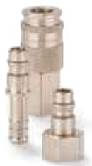
Dieses Kupplungssystem wurde speziell für den Bereich Atemschutz entwickelt. Kupplungssystem mit Einhandbedienung. High Flow Ventil für optimale Durchflussleistung und geringen Druckabfall. Die Sicherheitsverriegelung verhindert ein unabsichtliches Entkuppeln. Beim Entkuppeln muss der Stecker zunächst gegen die Kupplung gedrückt werden, erst dann kann entriegelt werden. Profil unverwechselbar mit Serie 96KS. Geprüft nach DIN EN 14593.
