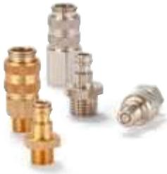
Mini-Industriekupplung mit dem weltweit verbreitetsten Profil dieser Nennweite. Überdurchschnittliche Durchflussleistungen für flüssige und gasförmige Medien. Das System verfügt zusätzlich über eine Sicherheitsverriegelung, d.h. das ungewollte Lösen der Verbindung wird verhindert. Beim Entkuppeln muss der Stecker zunächst gegen die Kupplung gedrückt werden, erst dann kann entriegelt werden.
