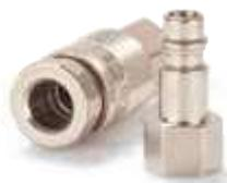
Dieses Kupplungssystem wurde speziell für den Bereich Atemschutz entwickelt. Kupplungssystem mit Einhandbedienung. High Flow Ventil für optimale Durchflussleistung und geringen Druckabfall. Die Sicherheitsverriegelung verhindert ein unabsichtliches Entkuppeln. Beim Entkuppeln muss der Stecker zunächst gegen die Kupplung gedrückt werden, erst dann kann entriegelt werden. Geprüft nach DIN EN 14593.
