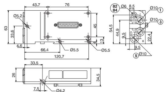
Anschlüsse 82/84=Pilotventillüftung, nicht mit Druckluft beaufschlagen.
