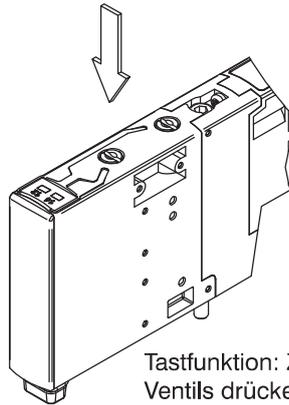
Tastfunktion: Zum Schalten des Ventils drücken (beim Loslassen geht das Ventil zurück in die Grundstellung)
