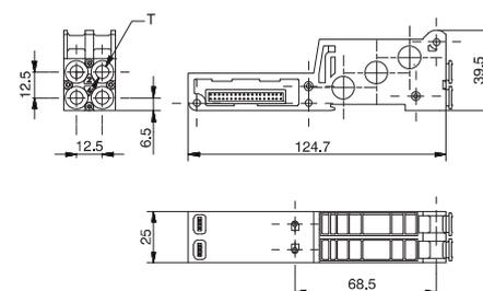
Kurzbestellbezeichnung "7" (für monostabil Ventile) standard (1-3-5 durchgängig)
