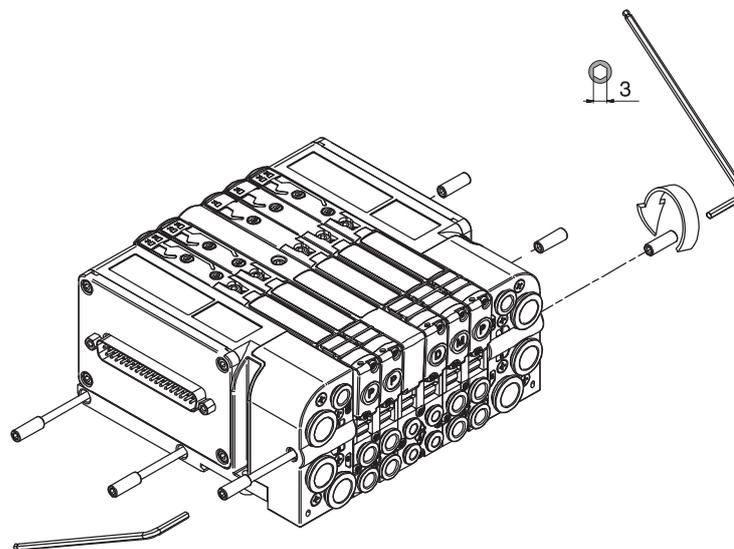
min. Anzugsmoment der Zugstangen: 2 Nm
