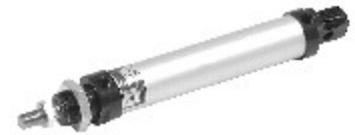
Die Standardausführungen sind voll austauschbar nach ISO 6432, von Durchmesser 8 bis 25 mm. Die Durchmesser 32, 40 und 50 mm sind in der ISO-Norm nicht enthalten und basieren auf unseren Spezifikationen. Für alle Größen sind Montagebauteile einsetzbar. Bei einfachwirkenden Zylindern ist zu beachten, daß der Hub max. 40 mm beträgt, darüberhinaus verändert sich die Gesamtlänge nicht proportional zum Hub, sondern wird länger (und der absolut längste Hub ist 100 mm).
