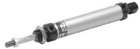
Die Ausführung "E" entspricht der Standardversion, jedoch mit sechseckiger Kolbenstange, um ein Verdrehen der Kolbenstange zu verhindern bzw, um die an der Kolbenstange montierten Teile in ihrer Position zu halten. Bei einfachwirkenden Zylindern ist zu beachten, daß der Standardhub max. 40 mm beträgt, längere Hübe sind auf Anfrage lieferbar, die Längenänderung des Zylinders ist jedoch nicht proportional zum Hub (Hub max. 100 mm).
