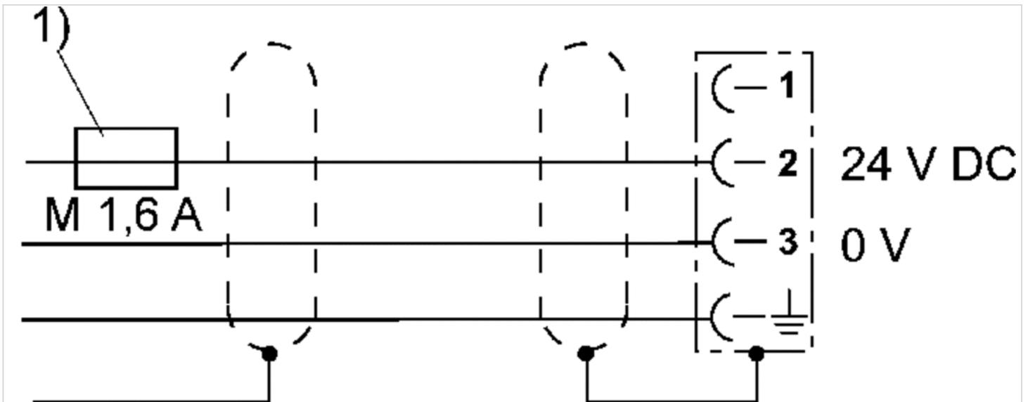
1) Die Betriebsspannung muss mit einer externen Sicherung M 1,6 A abgesichert werden.
