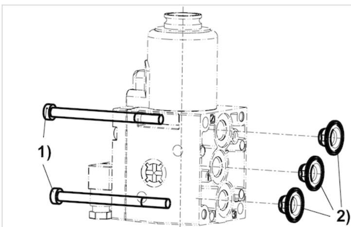
1) 2 Schrauben 2) 3 Dichtungen
