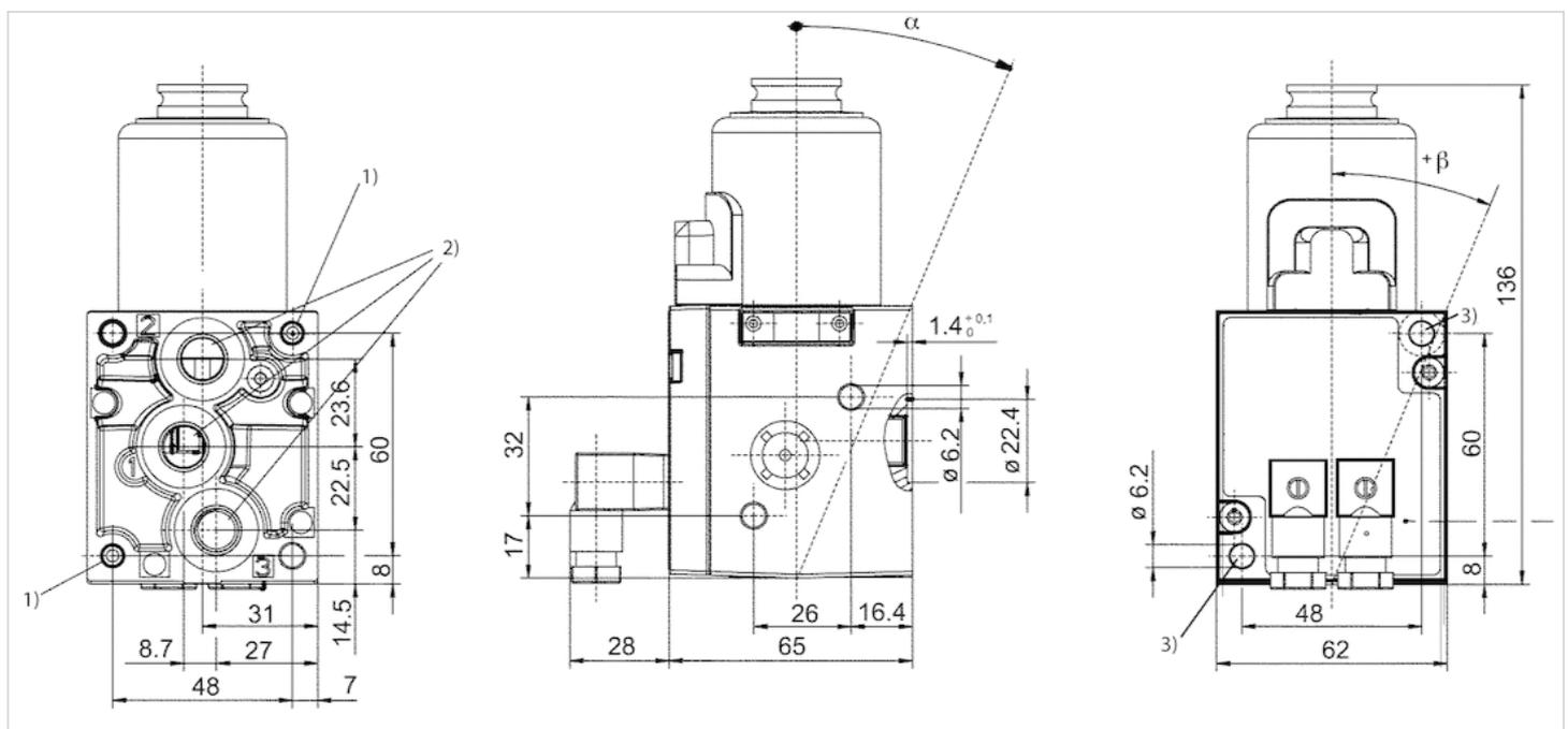
1) Kernloch 15 tief für selbstschneidende Schraube M6
